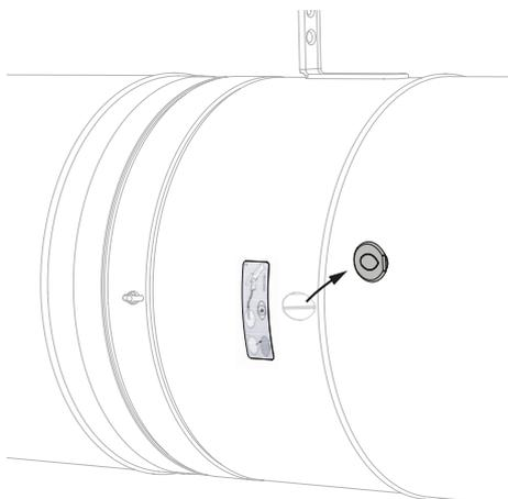
1. Une ouverture d'inspection (uniquement disponible en cas de commande de l'option 'UL') permet de déterminer visuellement la position et l'état du clapet à l'aide d'un endoscope.
