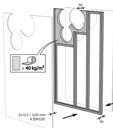
6. Assemblez la paroi légère en prévoyant les chevêtres horizontaux et verticaux nécessaires pour la réservation. Dans la réservation autour des clapets ( $D_n + 50$  mm), le vide entre les plaques de plâtre cartonné est rempli de laine de roche d'une densité minimale de  $40 \text{ kg/m}^3$ .
