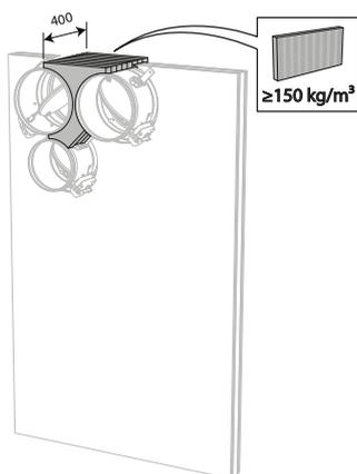
7. Installez et fixez les clapets dans la réservation. Colmatez la réservation du côté des distances minimales à l'aide de panneaux rigides de laine de roche ( $\geq 150 \text{ kg/m}^3$ ) sur une profondeur de 400 mm (150 mm du côté mécanique de la paroi). La surface de ce colmatage est fixée entre les axes (centres) des clapets.
