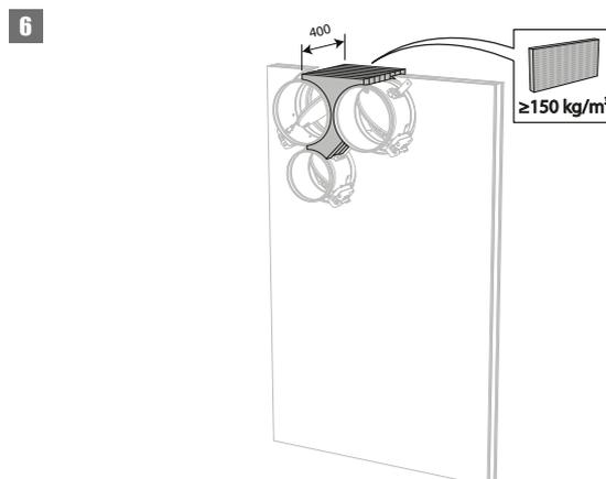
6. Installez et fixez les clapets dans la réservation.
