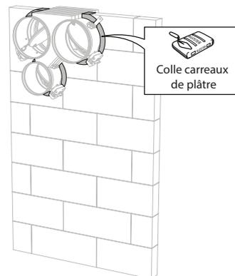
6. Colmatez le reste de la réservation à l'aide de colle à carreaux de plâtre sur l'épaisseur totale de la paroi.
