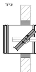
1. Sceller le clapet coupe-feu avec un colle à carreaux de plâtre.
