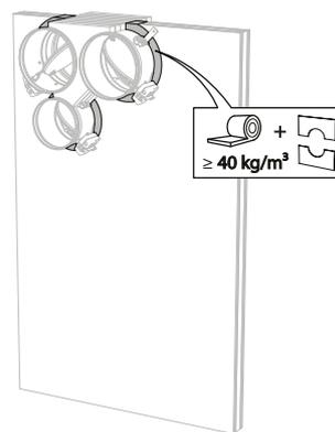
8. Colmatez le reste de la réservation à l'aide de laine de roche  $40 \text{ kg/m}^3$  sur l'épaisseur totale de la paroi.
