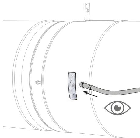
2. Introduisez la caméra de l'endoscope (par exemple Inspecam Rf-t) dans l'ouverture et inspectez l'intérieur du clapet.
