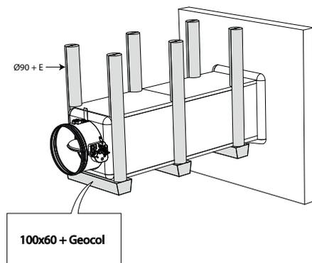
7. Les tiges filetées sont protégées par ½ coquilles en staff  $\varnothing 90$  mm et maintenues entre elles par colle et polochonnage. La traverse est protégée par un profilé en « U » de protection en GEOFLAM 100 x 60 mm, collé à la sous-face du conduit par du plâtre pour collage de type GEOCOL (GEOSTAFF).
