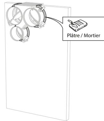
6. Colmatez le reste de la réservation avec du mortier standard ou du plâtre dans une paroi massive. En cas d'utilisation dans une dalle massive : colmatez avec du mortier standard.
