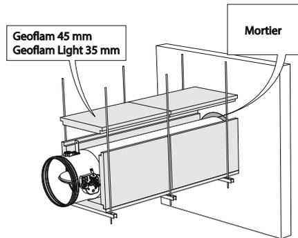
5. La réservation autour de la gaine dans la paroi est remplie par du mortier standard. La gaine traversante est recouvert de plaques de staff de référence GEOFLAM F d'épaisseur 45 mm ou GEOFLAM Light d'épaisseur 35 mm « G ». Les plaques sont fixées entre elles autour de la gaine par colle et polochonnage « E ». Le corps du clapet est également ainsi protégé sur une longueur de 171 mm.
