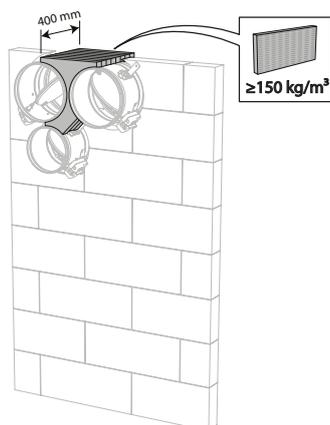
5. Installez et fixez les clapets dans la réservation.
