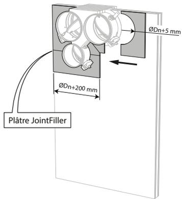
9. Finissez la surface des 2 côtés avec des talons de plâtre. Rejointoyez les espaces entre les talons et entre talons et plaques à l'aide de jointfiller.
