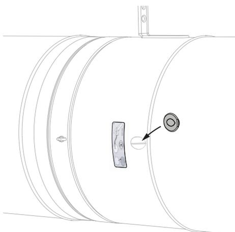
3. Après inspection, remettez le bouchon de fermeture soigneusement en place. La position est importante pour le maintien de l'étanchéité à l'air du clapet.
