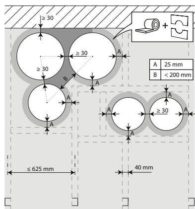
5. Les clapets peuvent être installés à distance minimale ( $\geq 30$  mm) d'une paroi ou d'un autre clapet.
