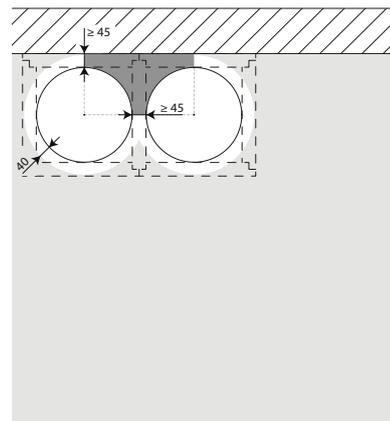
8. Les clapets peuvent être installés à distance minimale d'une paroi ou d'un autre clapet.
