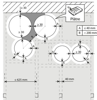
4. Les clapets peuvent être installés à distance minimale ( $\geq 30$  mm) d'une paroi ou d'un autre clapet.
