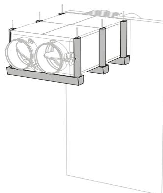
13. Colmatez l'espace du côté des distances minimales à l'aide de panneaux rigides de laine de roche ( $150 \text{ kg/m}^3$ ) sur une profondeur de 150 mm.
